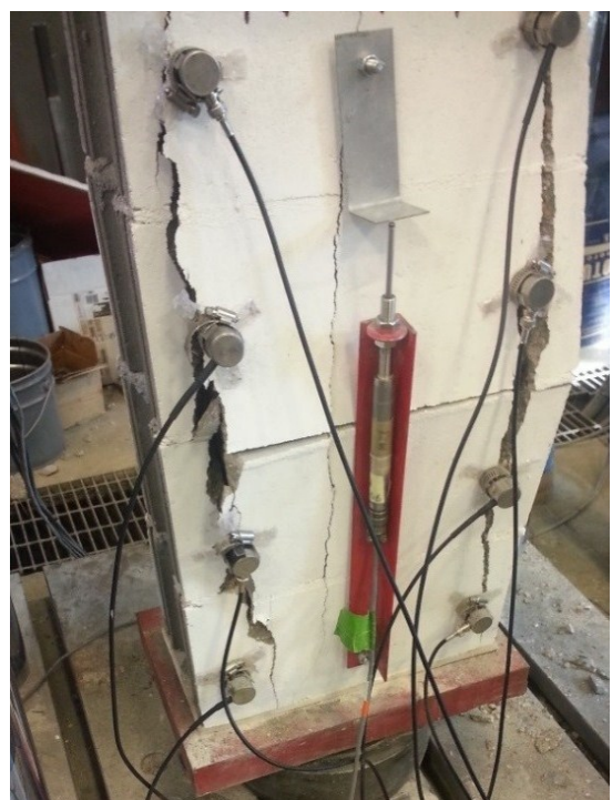
(d) Normal CMU Grouted
